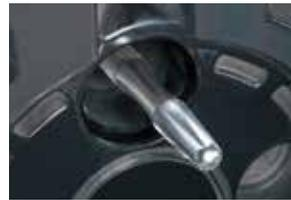
くぼみのある独自の形状で、ホイール取付け時の位置合わせの調整がしやすく、ホイールの脱落を防止します。
