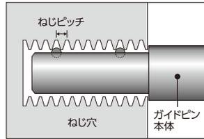
先端のボールがピッチ溝にしっかり固定されることで、差し込みやすく抜けにくい。
