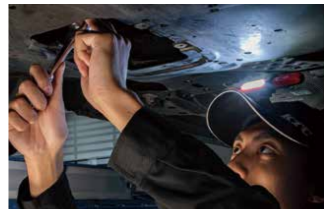
ヘッドホルダを装着することで、ヘッドライトとして使用でき、両手作業も可能です。
