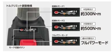
モード切替ボタンを押すだけで、3つのモードの切り替えが可能。ホイールナットの締め過ぎを防止する仮締めモードを使えば、トルクレンチの本締め作業が素早く効率的に行えます。
