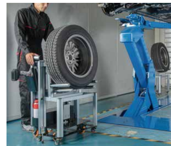
タイヤリフターと併せてお使いいただくことで、格段に作業効率がアップ! 大型タイヤのローテーション作業もスムーズに行えます。
