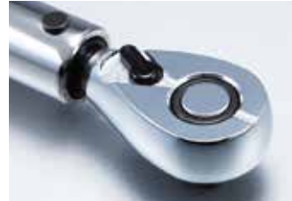
ラチェットヘッド部は押しボタンを押さない限り、ソケットの脱着を行えないユニオン機構採用。作業中のソケットの落下防止にも有効 ※CMPB8006、CMPB8008を除く
