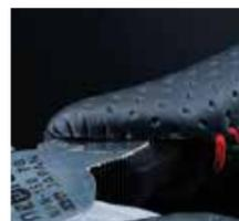
美しい仕上がりを見せる根元部。接着面が小さく、革への事前加工と曲げ込んで接着する際の高い技術が必要とされる。
