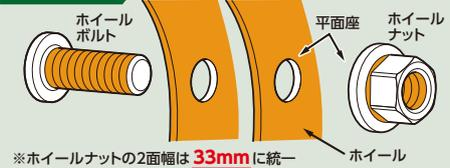
大型車のホイールは従来のJIS方式からISO方式に移行しています。JIS方式とISO方式が混在する現在、JIS方式に対応したコンビソケット、ISO方式に対応した33mmのソケット、その他の足回り作業に必要なソケットを1セットにしたKTCのソケットセットで**一括管理**&作業効率アップを!
