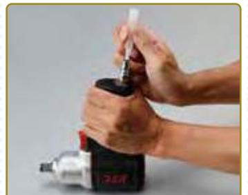
ソケットなどの先端工具とエアホースを外してエアカプラからエアツール用オイルを3~5滴注入しトリガーを握ります。
