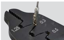
自動車細線の端子かしめにも対応。
