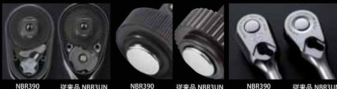
ギアは小判型ヘッドとしては世界最多の90枚。かつてない滑らかな動きと、強度<sup>※</sup>を実現。90枚ギア、送り角4°、7段クローの精密な駆動機構をコンパクトなヘッドサイズに凝縮しながら、従来品と同等の強度、サイズを誇ります。 ※nepros NBR3UNとの比較において、同クラスの強度を実現
