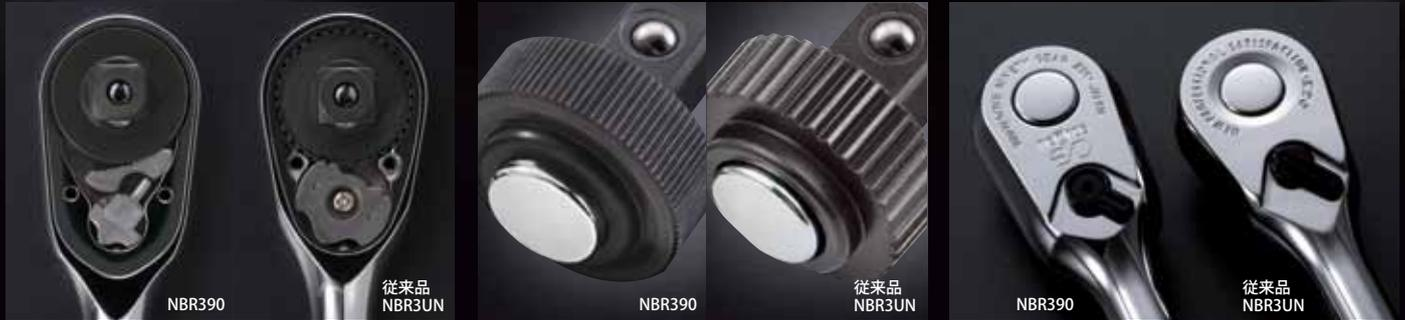
ギアは小判型ヘッドとしては世界最多の90枚。かつてない滑らかな動きと、強度\*を実現。90枚ギア、送り角4°、7段クローの精密な駆動機構をコンパクトなヘッドサイズに凝縮しながら、従来品と同等の強度、サイズを誇ります。\*nepros NBR3UNとの比較において、同クラスの強度を実現
