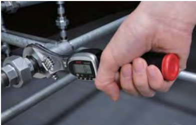
ソケットレンチなどが使用できない配管等の作業に適しています。
