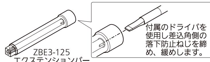
付属のドライバを使用し差込角側の落下防止ねじを締め、緩めします。
