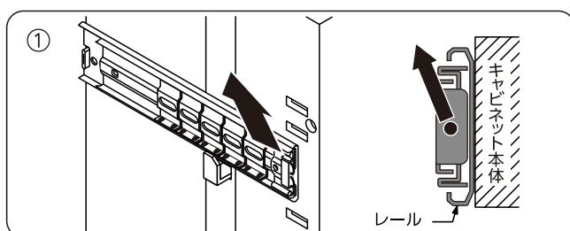
①「引出し」を取り外した後、レール前面側を斜め上方向に引き上げる。
