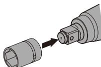
先端工具の取り付け後、作業前にソケットの装着状態を確認する。
