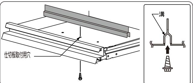
「引出し」にある仕切板取付用穴と仕切板にある溝をあわせ、「引出し」下側からビスで止める。
