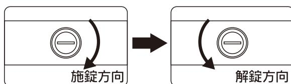
1段目が引き出された状態で、カギを「施錠」方向に回した後、「解錠」方向に回すと、セーフティーロック機構が解除され、さらにもう1段引き出すことができます。
