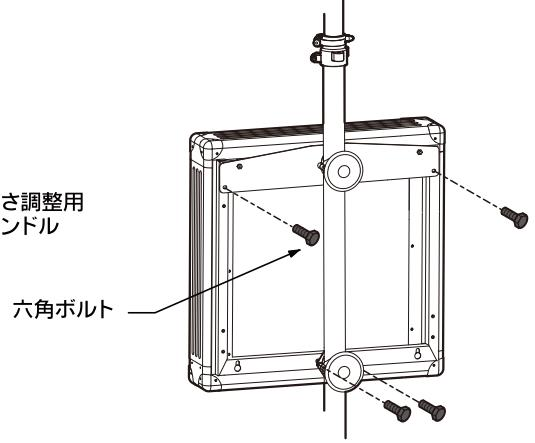
EKSアタッチメントの取付用ピンにEKS本体のカギ穴を使用し掛ける。
