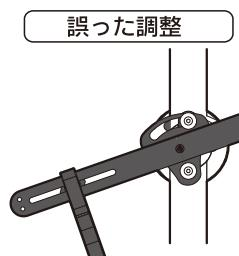
自転車アタッチメントフックの角度調整を最大限に調整しても、自転車の前後輪が水平にならない場合は、その自転車をスタンドに掛けることはしないでください。
