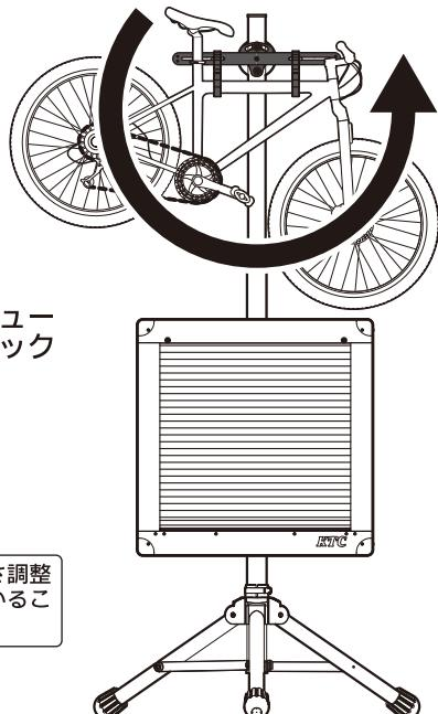
自転車のトップチューブが大きく傾いている自転車は自転車アタッチメントフックの角度調整用ボルトを緩め、自転車の前後輪が水平になるように調整して自転車を掛けてください。
