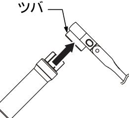
専用ソケットをベルトレンチのツバ側に装着し、テンション調整ボルトに掛け作業する。
