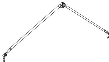
破損した側のエンジンルームの対角にあてがい 破損度合いを確認する。
