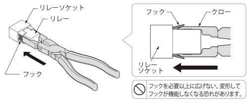
②リレープライヤーでリレーをしっかりと掴み、矢印の方向に引き抜く。
