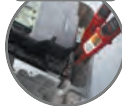
作業前の電圧測定は車両メーカーの整備指示書に指定されています。
