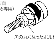
角の丸くなったボルト
