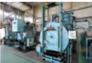
▲ ワーク洗浄までを自動化した真空焼入れ・焼戻しライン
