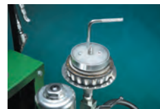
取り外したベアリングにはコーンへのセットによりグリース注入が可能
