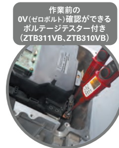
作業前の電圧測定は車両メーカーの整備指示書に指定されています。
