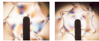
従来のボルト・ナット トルクス形状
