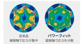
ソケットの口径部と差込角部には、KTC独自のパワーフィット形状を採用。接触面積をより大きくすることでエッジを備めにくく、安全な作業が可能です。
