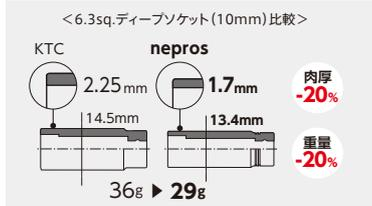
ソケットは強度・靱性・耐久性を備えた材料と高度な熱処理技術を採用し、KTCブランドと同等の強度ながら薄肉・軽量化を実現しています。
