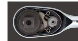
ラチェットハンドルは、6.3sq.規格のコンパクトなボディに、neprosが誇る90ギアを搭載。送り角はわずか4°です。妥協のないメカニズムが安全で確実、高い作業性を表現します。
