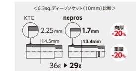
ソケットは強度・靱性・耐久性を備えた材料と高度な熱処理技術を採用し、KTCブランドと同等の強度ながら薄肉・軽量化を実現しています。
