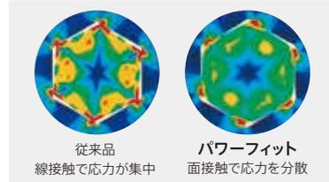
ソケットの口径部と差込角部には、KTC独自のパワーフィット形状を採用。接触面積をより大きくすることでエッジを傷めにくく、安全な作業が可能です。
