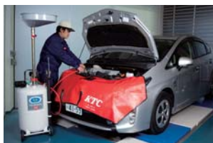
上抜きであれば、ボンネット内の他の作業(バッテリーチェック等)もOK! 効率UP!にかかせません。
