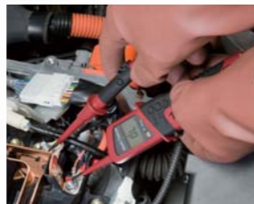
作業前の0V(ゼロボルト)確認ができるボルテージテスター
