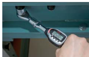
ヘッドを裏返しての使用が可能。(ヘッド交換式のみ)
