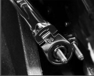
サイドブレーキアジャスターなど狭い場所での使用に最適。突き出したボルトにも対応する貫通ソケットタイプです。
