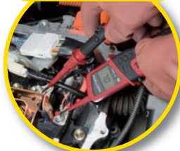
作業前の電圧測定は車両メーカーの マニュアルで指定されています。
